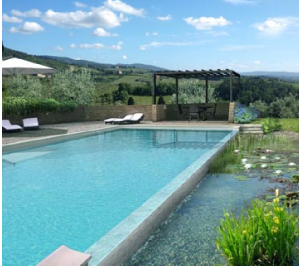
Biopiscina a Rocca d'Orcia, comune di Castiglione d'Orcia, Siena. In questo caso la piscina originaria è stata ampliata integrando un'area di fitodepurazione sul lato longitudinale.
